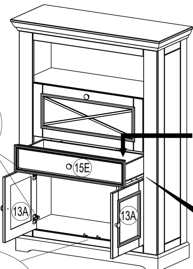
"Die Schubkastenschiene kann bei Bedarf durch Lösen und Fixieren der Schraube am Langloch eingestellt und nachjustiert werden"
