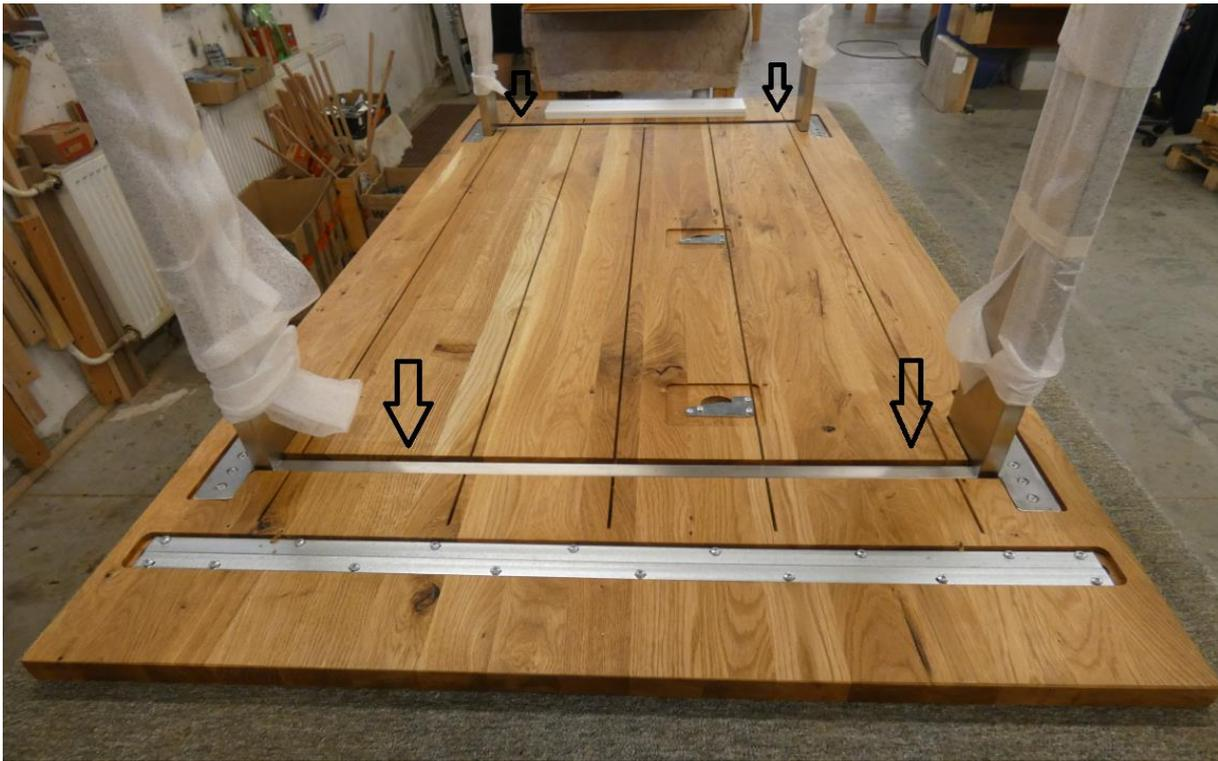
**2a. Befestigen Sie die Füße mit je 6 Schrauben pro Seite (4x 6 Schrauben)**
