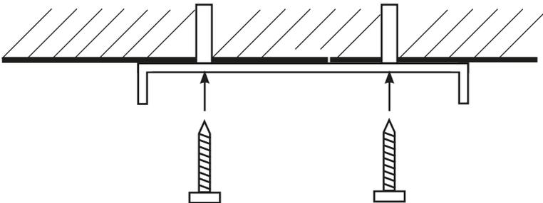
**allnatura-TIPP:** Verwenden sie je nach Beschaffenheit der Decke passende Dübel um die Deckenhalterung mit der Decke zu verbinden. Somit erreichen Sie die maximale Festigkeit der Verbindung. Um ein Herabfallen der Leuchte zu vermeiden.
