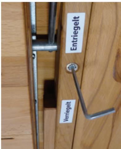
1. Die Höhenposition des Metallrohrs, auf welchem die Klappeinlagen befestigt sind, kann entlang der Querholme mittels der darunter liegenden Inneninbusschrauben verändert werden.
