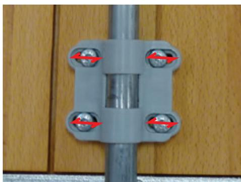
4. Die waagerechte Position der Klappeinlagen kann mittels der Langlöcher in den grauen Befestigungsmanschetten verändert werden. Lösen Sie leicht die Verschraubung an den Manschetten und verschieben Sie danach die Klappeinlagen in die gewünschte Richtung. Klappen Sie die Klappeinlagen auf und überprüfen Sie das Ergebnis. Gegebenfalls wiederholen Sie diesen Schritt erneut, ansonsten schließen Sie die Justierung ab, indem Sie die Schrauben an den Manschetten wieder festziehen.
