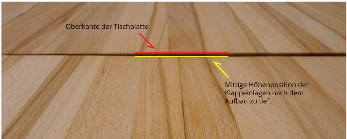
**Beispiel 1:** Die Klappeinlagen der Auszugseinheit haben MITTIG einen vertikalen Höhenversatz zur Tischplatte z. B. 3mm
