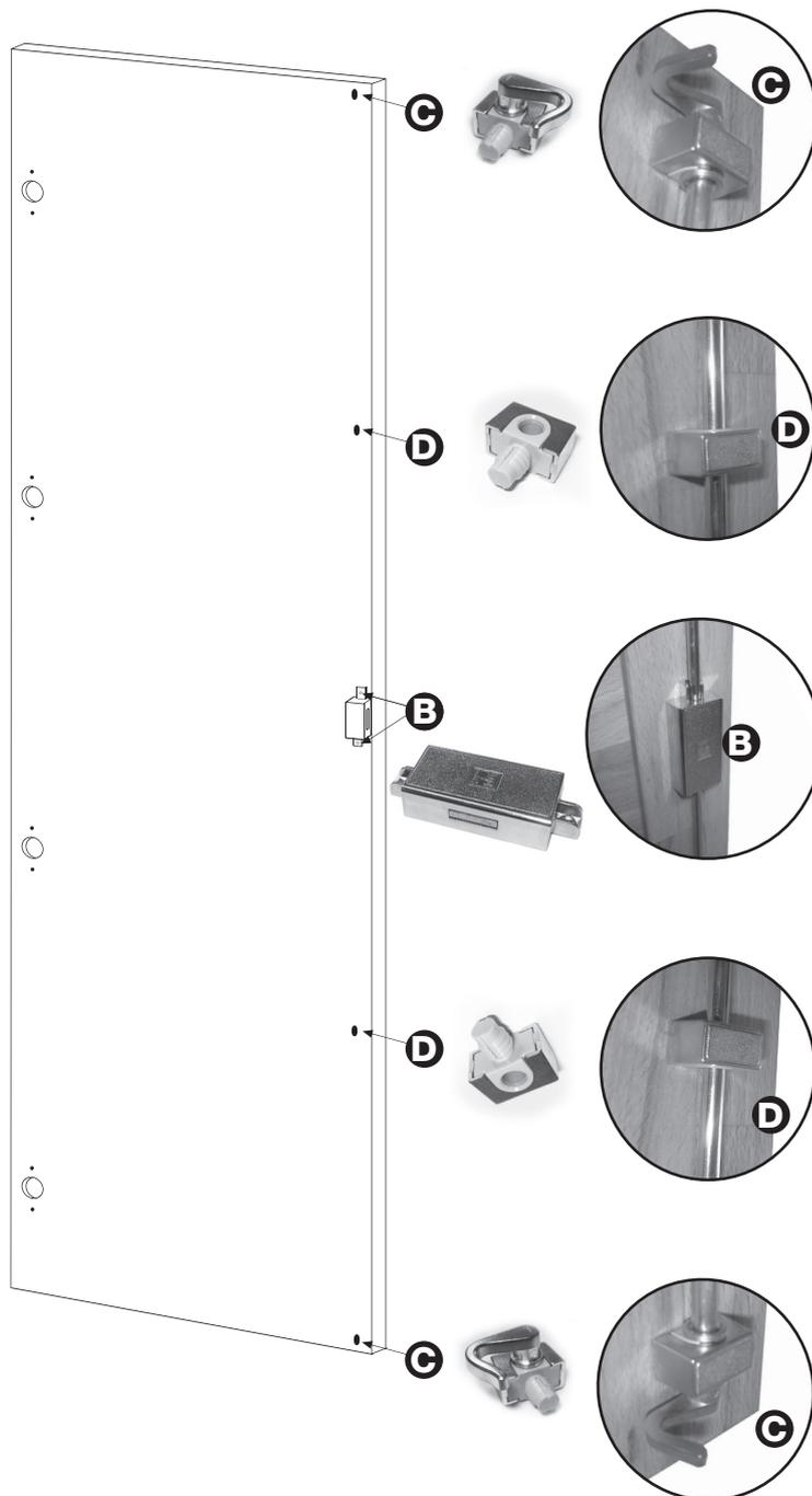
Schließhakenmodul **(C)** oben und unten in das vorgebohrte Loch einsetzen und mit leichten Hammerschlägen fixieren. Achten Sie darauf das die Schließhaken richtig sitzen und jeweils hinter die Schließbolzen **(F)** greifen können.
