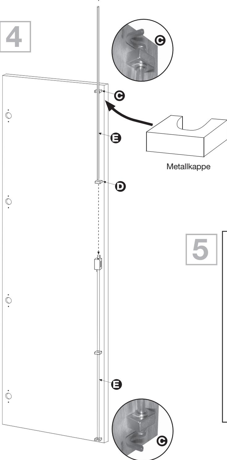
Schließstange (E) durch Führungsmodul (D) stecken und passgenau in Schloß (B) einführen.
