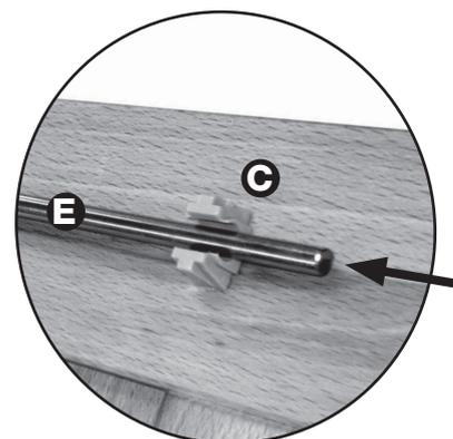
Damit Sie die Schließstange **(E)** einführen können, müssen Sie bei den eingesteckten Schließhakenmodulen **(C)** die Metallkappe entfernen und anschließend den Schließhaken herausnehmen.
