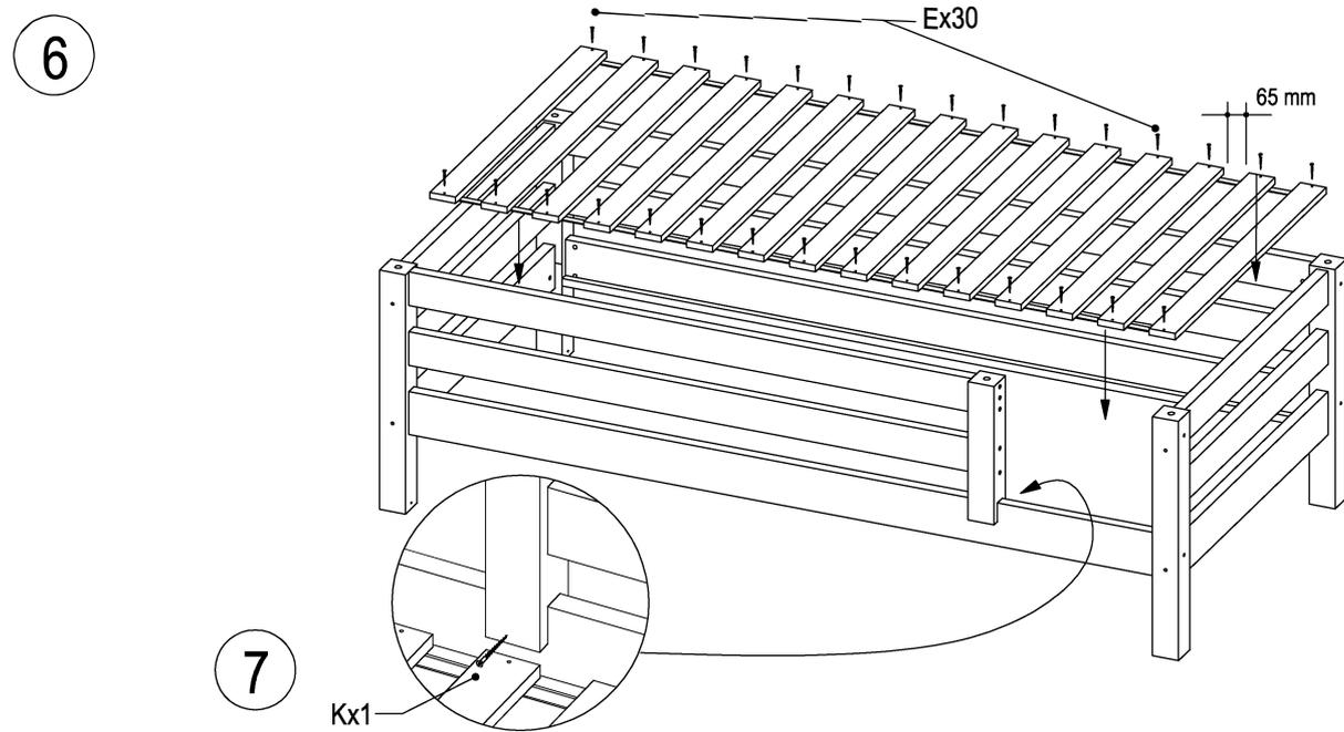
Bei Montage des Lattenrostes die erste und die letzte Leiste bis an die Pfosten herschieben und alle Leisten fest schrauben.
