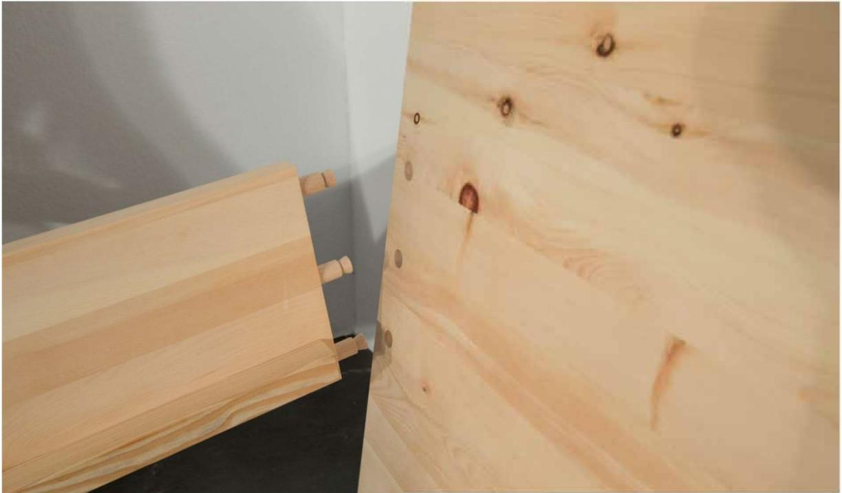
Stecken Sie das Seitenteil mit den Graddübeln durch das Kopfteil und befestigen Sie es auf der Rückenseite mit dem beigelegten Gradgegenstück.
